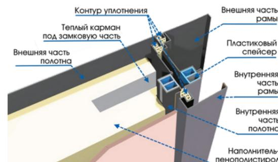
**Терморазрыв** – двухкамерный пластиковый спейсер на полотне и коробе, исключая появление мостиков холода
